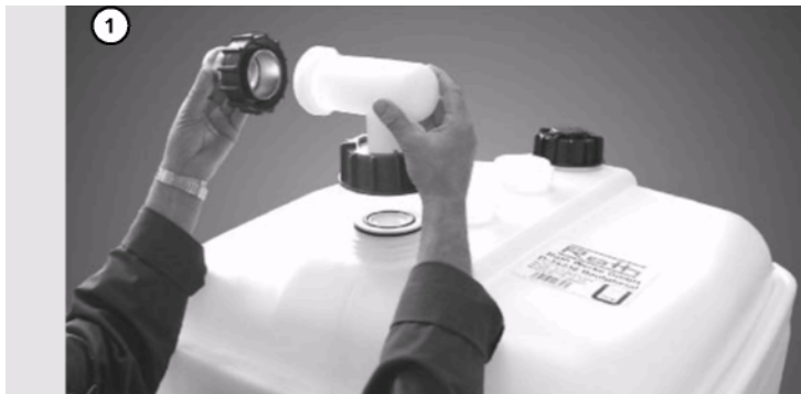
1 Угловую заливную трубку и заливное соединение LORO-X на первом штуцере резервуара установите вместе со вставленной погружной трубой; смажьте консистентной смазкой уплотнительные кольца.
